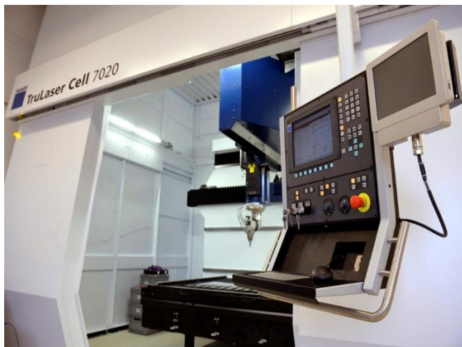
4. ábra 4kW TRUMPF szilárdtest diszklézer + CNC-cella
